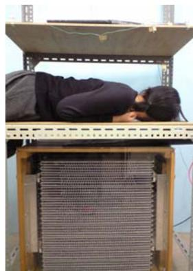
図 2. 人体を通過した $\mu$ 粒子による測定の様子
